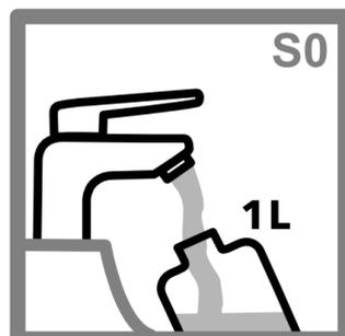
2. 1 L Probe entnehmen (S0-Probe)\*<sup>2</sup>; als Probenbehältermaterial wird PE oder PP empfohlen
