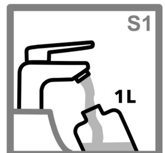
4. Entnahmehahn öffnen und 1 L Probe entnehmen (S1-Probe)\*<sup>2</sup>
