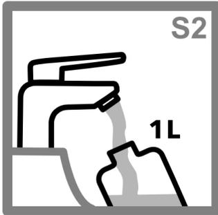
5. Hahn nicht schließen und direkt den nächsten Liter Probe entnehmen (S2-Probe) \*2
