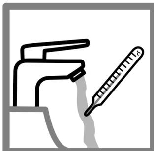
1. Warmwassereckventil schließen; Entnahmestelle öffnen und Wasser bis zur Temperaturkonstanz ablaufen lassen
