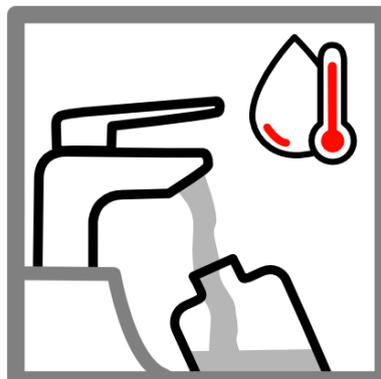
5. Anschließend direkte Abfüllung der Probe in das Probenahmegefäß ohne Schließen und erneutes Öffnen der Entnahmemarmatur
