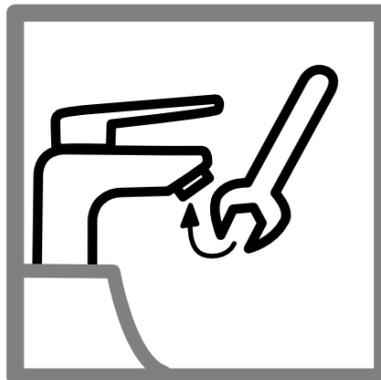
2. Strahlregler am Wasserhahn entfernen; entfällt bei Duschkopf
