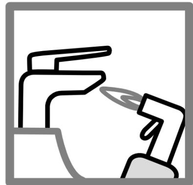
3. Entnahmemarmatur an der Öffnung gründlich abflammen oder alternativ chemisch desinfizieren
