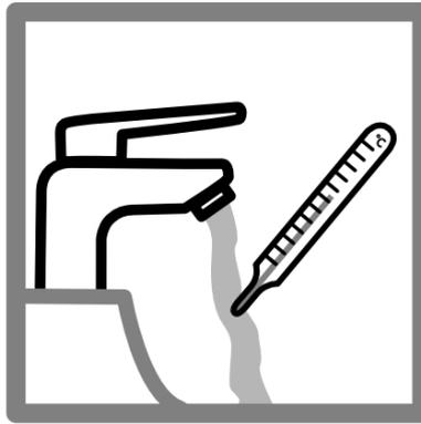
**8.** Abfließen lassen des Trinkwassers aus der Entnahmemarmatur bis zur Temperaturkonstanz und Messen der Temperatur; Bitte als „Konstante Temperatur“ notieren
