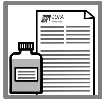
**9.** Probe beschriften und mit Untersuchungsauftrag zur LUFA Nord-West geben; die Probe muss gekühlt werden ( $5 \pm 3 \text{ }^\circ\text{C}$ ) und spätestens 48 h nach der Probenahme im Labor angesetzt werden
