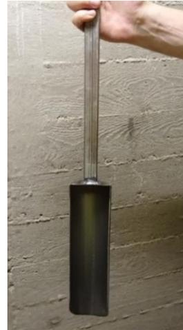
■ Probenahmestab (Kammerstecher) mit einem oder mehreren Fächern/Kammern:
